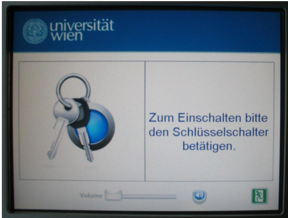
Nach Betätigung des Schlüsselschalters wird die AV-Anlage hochgefahren und am Touch-Bedienpaneel erscheint die Haupt-Bedienseite.
