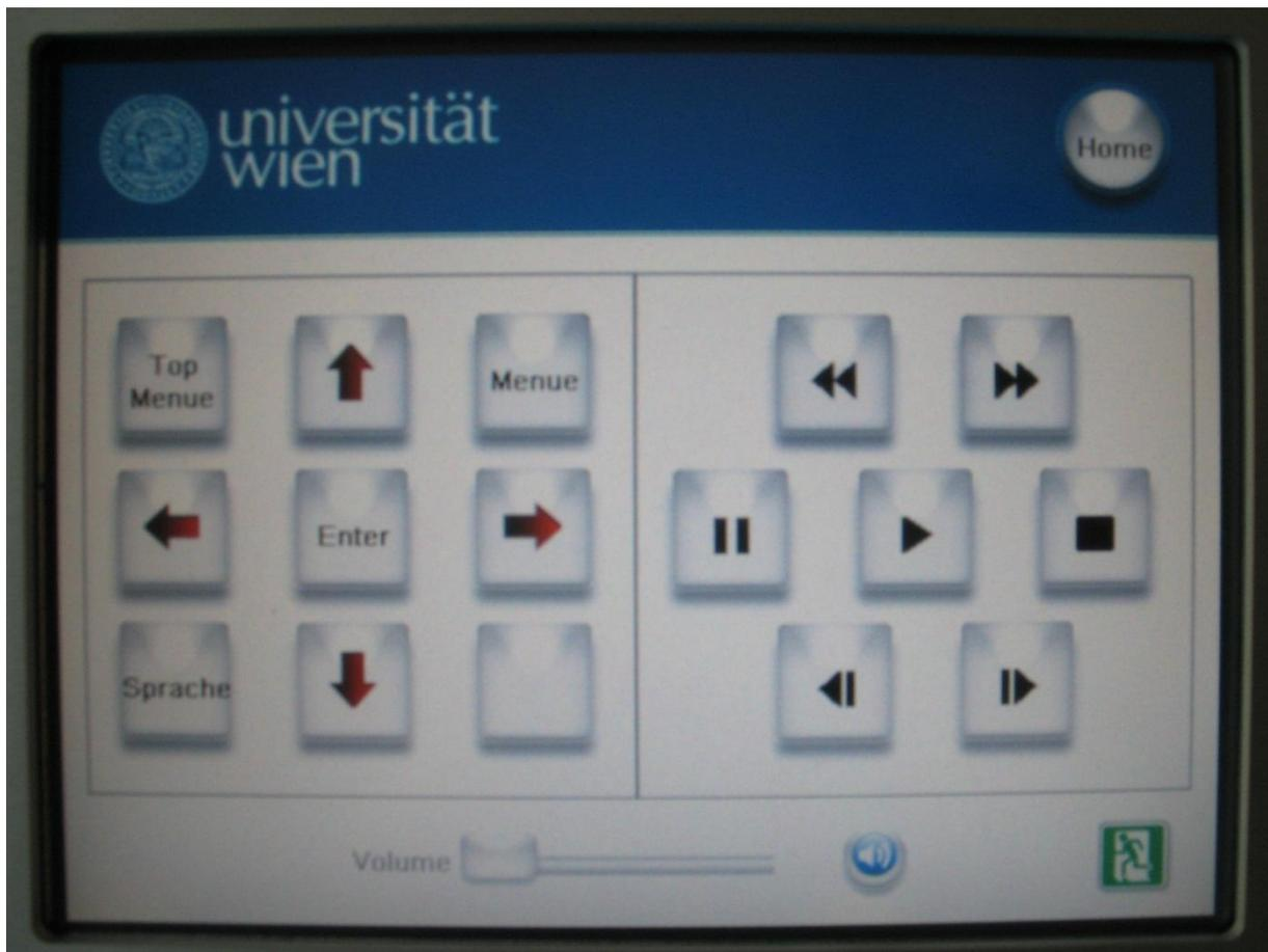
Sämtliche für die Bedienung des eingebauten BluRay-Players benötigte Befehle sind auf dem Touch-Bedienpaneel abgebildet.
